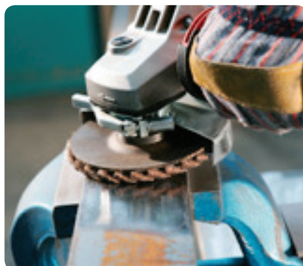
Професионално отстраняване на ръжда и пръски от заваряване
